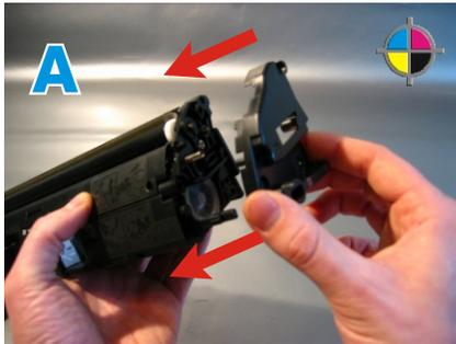
**10. Schritt:** *Kunststoffabdeckung aufsetzen*
