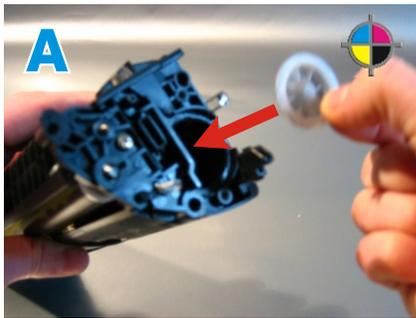
**9. Schritt:** *Füllstutzen einsetzen*
